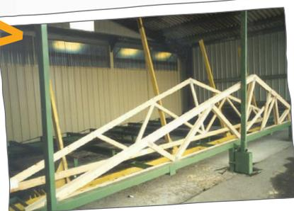
Le bras releveur va redresser les fermettes jusqu'au stockage vertical.
