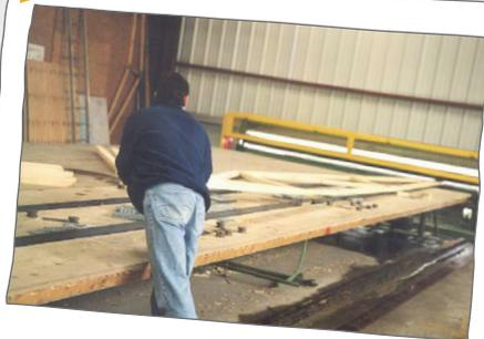
Les éjecteurs relèvent la fermette réalisée, il suffit de pousser la fermette vers la table à rouleaux (jaune) qui l'évacue à l'extérieur par la fente aménagée dans la cloison.
