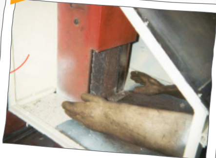
Boîte à gants (Porte latérale ouverte pour introduire les pièces)
