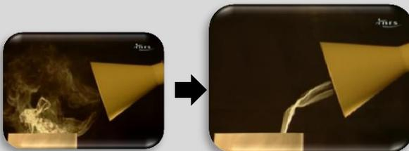
**6. Répartir uniformément les vitesses d'air au niveau de la zone de captage.**
